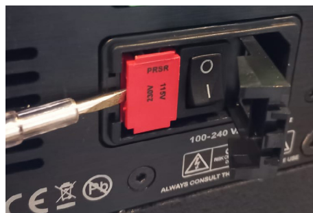
步骤 2：如图所示，使用平头螺丝刀拆下保险丝座。
