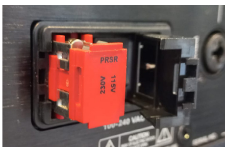
步骤 3：拆下保险丝座并旋转，需要的电压额定值朝左。
