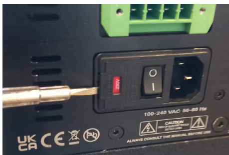
步骤 1：如图所示，使用平头螺丝刀拆下保险丝座盖。
